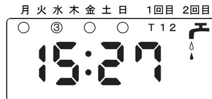
散水中は現在時刻が表示され、蛇口から水滴が落ちる表示をします。
