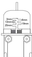
感知雨量の調節を行う場合には、センサーキャップを回転させ、希望する降雨量の位置に設定します。強くひねるとピンが壊れるのでご注意下さい。センサーが作動して、散水を中止した後の復旧時間は天候状況で変化します。センサーキャップ下の換気孔のリングを回して、開き具合を調整すると乾燥までの復旧時間が調整出来ます。
