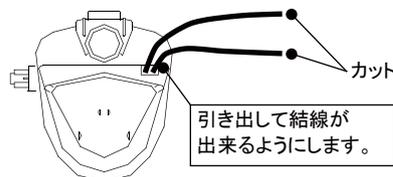
③センサーの結線を適当な長さにカットします。(1本になっている部分から15cm程度)
