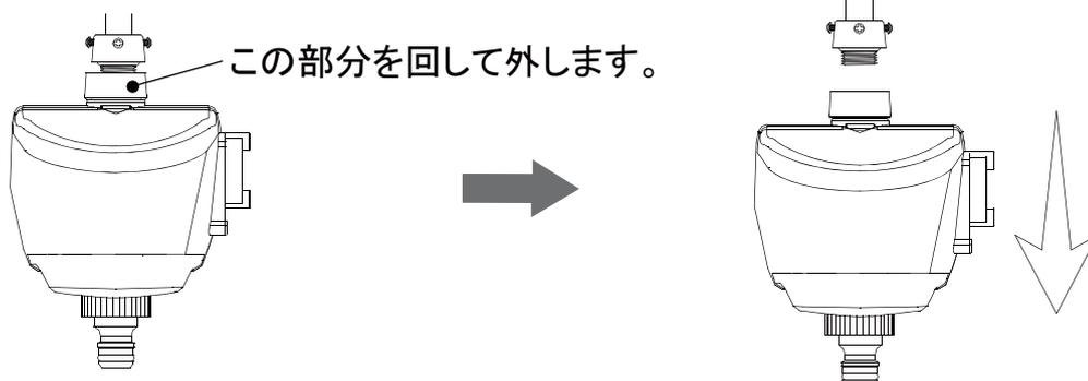
5：コントローラーを逆さまにして、数回降って内部の水を抜きます。
