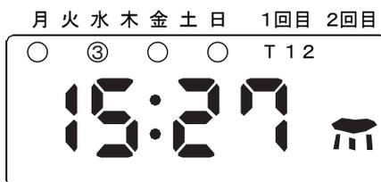
スイッチをセンサー作動にして、降雨がありセンサーが働いている場合は現在時刻と、雨雲のマーク表示され、自動散水は行われません。手動運転も出来ませんので、解除して下さい。（解除手順は15ページ参照）
