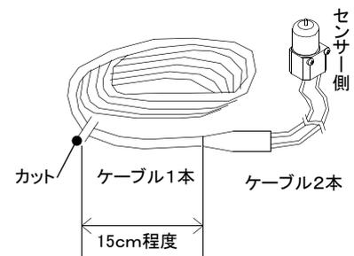
④センサー用ケーブルとセンサーの結線をします。
